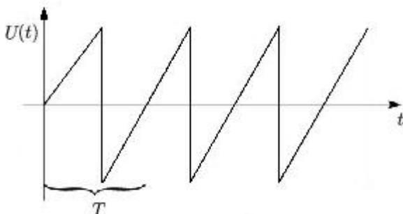
Der Elektronenstrahl bewegt sich hier also in T von links nach rechts und wird dann, mittels abrupter Spannungsänderung, in sehr kurzer Zeit in seine Ausgangslage zurückgesetzt, was dazu führt, dass der Verlauf der äußeren Spannung auf dem Schirm „gemalt“ wird.
