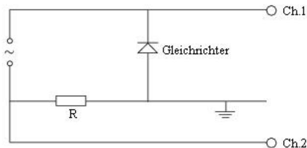
Ein Gleichrichter lässt Strom nur in eine Richtung passieren. In den Kreis ist ein  $1k\Omega$  -Lastwiderstand eingebaut. Desweiteren soll später noch ein Kondensator hinzugefügt werden:
