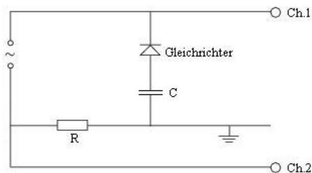
Dieser führt sowohl zu einer Phasenverschiebung von Eingangs- und Ausgangssignal, als auch zu einem kleinen Ausgleich der stromlosen Abschnitte durch Abgabe der auf ihm gespeicherten Ladung. Die Messungen sollen mit verschiedenen Eingangs(spitzen)spannungen von 0.5V, 1V und 8V durchgeführt werden.
