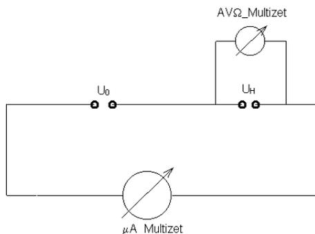
Durch Veranderung der Spannung  $U_H$  wird die resultierende Spannung auf Null heruntergeregelt. Jetzt sind  $U_H$  und  $U_0$  gleich, somit ist die gesuchte Spannung  $U_0$  bekannt. Die Kompensationsschaltung wird angewendet, wenn die Stromquelle einen nicht vernachlassigbaren Innenwiderstand hat - also die Spannung bei zunehmendem Stromfluss sinkt.
