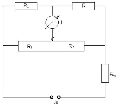
Das Potentiometer wird nun so eingestellt, dass durch das Strommessgerät („Brücke“) kein Strom mehr fließt. Mit dem bekannten Widerstand  $R = 1 \text{ k}\Omega$  und der Potentiometer-Einstellung (Verhältnis  $R_1 : R_2$ ) gilt dann für  $R_x$ :
