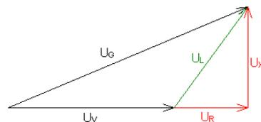
$U_L$  ist die Spannung über der Spule, die wir messen können. Sie setzt sich aus dem Ohm'schen Widerstand  $R$  der Spule und dem induktiven Widerstand (mit zugehöriger Spannung  $U_X$ ) zusammen. Wieder nach dem Satz des Pythagoras gilt:
