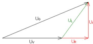
Zur Erinnerung:  $U_L$  ist die Gesamtspannung, die an der Spule abfällt (wird gemessen),  $U_R$  ist die Spannung am Ohm'schen Widerstand der Spule und  $U_X$  die Spannung, die über dem induktiven Widerstand  $R_X$  abfällt. Die Formel für den induktiven Widerstand lautet:
