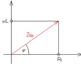
Bei unserer Messung erhalten wir den Gesamtwiderstand  $Z_{Sp}$  durch die an der Spule gemessenen Größen Spannung  $U_S$  und Strom  $I_S$ :
